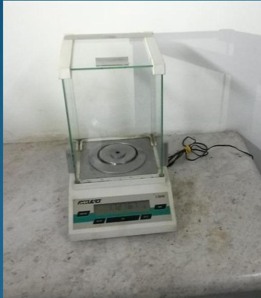
La medición debe de ser con una balanza analítica y en ambiente libre de humedad.
