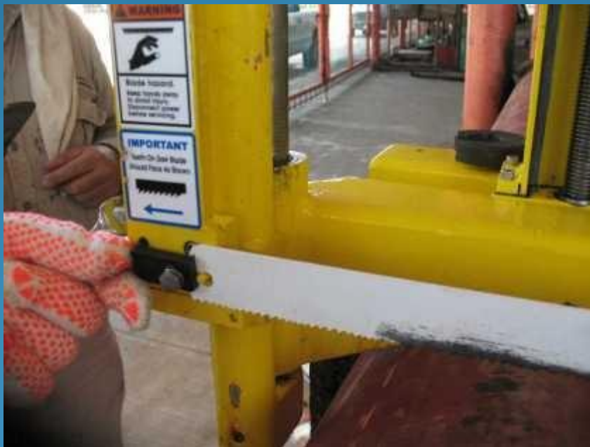
7.- SE COLOCA SEGURO EN LA GUIA DE LA SEGUETA
